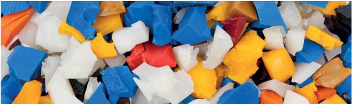
RUTEC R5000 kann sowohl vollflächig, als auch in Form einer Deckschicht auf einem bestehenden Sandgeschosfang verbaut werden. Wir empfehlen zusätzlich den Einbau einer Unterkonstruktion, um das Granulat am Abrutschen zu hindern, und eine Abdeckplane aus unserem Naturkautschuk (RUTEC R1078), um Verunreinigungen durch Fremdstoffe zu vermeiden.
